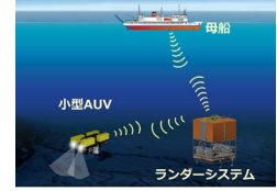
フルデプス対応試料採取探査システム概念図
