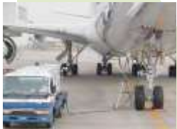
充電、圧縮空気・冷暖房 の供給、給水
