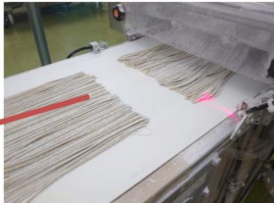
投入口が詰まる前にセンサーが感知し、回転灯が起動し、サイレンが鳴る。
