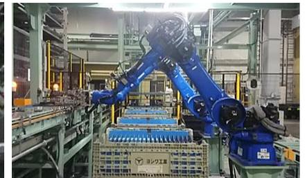
製造荷揃工程の自動化
