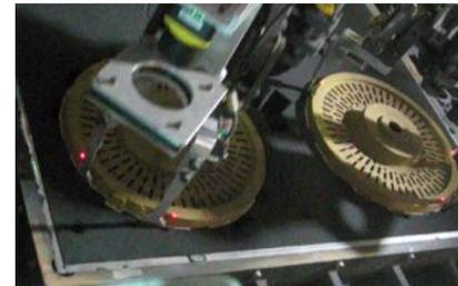
ロボットによる鑄型セット
