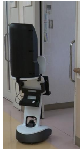
③ロボットが対象の患者病室へ入る。 (扉が開いている必要あり)
