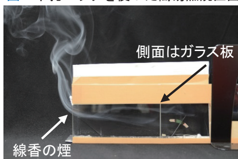
第6-9図 牛乳パックを使った簡易燃焼区画
