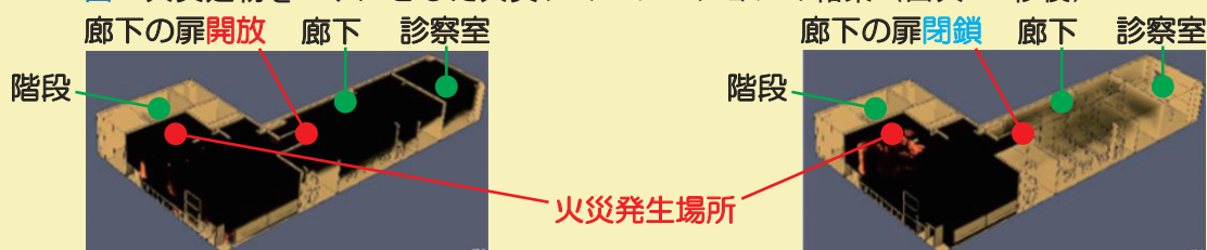
第1-1-20図 火災建物をモデルとした火災シミュレーションの結果（出火60秒後）
