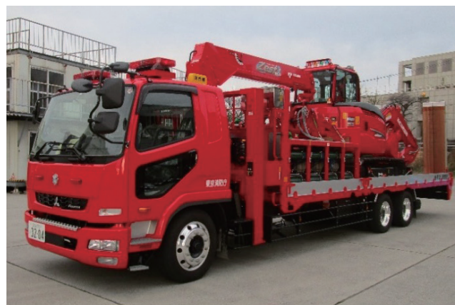
重機及び重機搬送車
