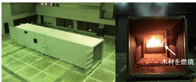
第6-7図 放水実験用の実大燃焼区画
