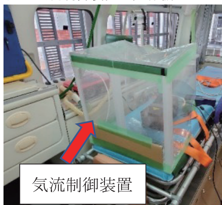
第6-14図 気流制御装置の試作機
