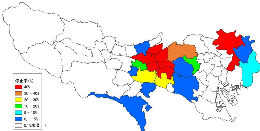
図 供給停止率(多摩東部直下地震)
