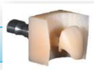
機器を用いてブロック状の材料から歯冠補綴物を削り出す
